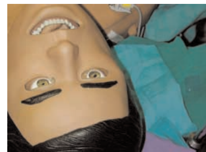
Abb. 5 ▲ Heutige Patientensimulatoren weisen dank Sprachproduktion, Lidschlag, Pupillenreaktion, Spontanatmung, CO 2 -Produktion und Sauerstoffverbrauch einen hohen Grad an Realität auf
